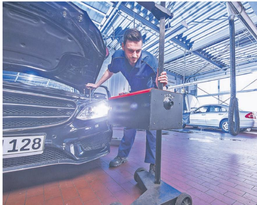
Beim Licht-Test werden neun Beleuchtungspunkte auf Sicht und Funktion sowie die Einstellung aller Lichtsysteme gecheckt.
