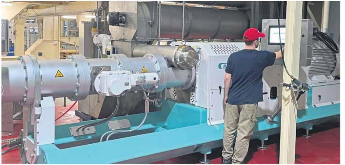
Der Extruder ist ein Beispiel für die Maschinen, mit denen Fachkräfte für Lebensmitteltechnik arbeiten.
