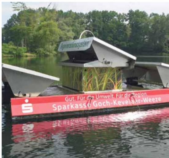
Mit dem Aquamotec-Zirkulationssystem wird die Wasserqualität in den Kalbecker Seen verbessert.
