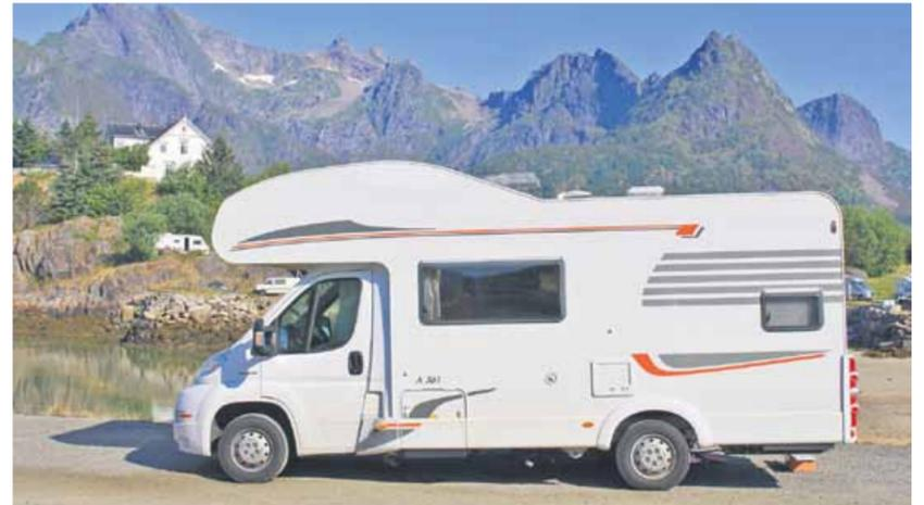
**Alkovenmodell:** Gut erkennbar ist die leicht überstehende, typische „Nase“, hier im Alkoven befindet sich der Schlafbereich.
