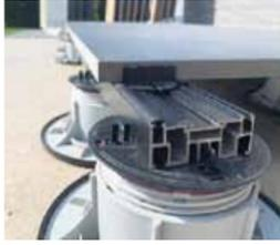
Die eigens für den Terrassenbau konzipierten, robusten Alu-Schienen sind 2 Meter lang und nur 26 mm hoch. Auf ebenem Untergrund können sie direkt mit einem Bodengummi verlegt werden, größere Konstruktionshöhen sowie den Ausgleich von Unebenheiten erzielt man in Kombination mit den perfekt passenden Solid-Terrassenlagern. Die Konstruktion benötigt keinerlei Befestigung zum Untergrund, kann dadurch also auch in Mietobjekten eingesetzt und, falls nötig, rückstandslos zurückgebaut werden. Die
