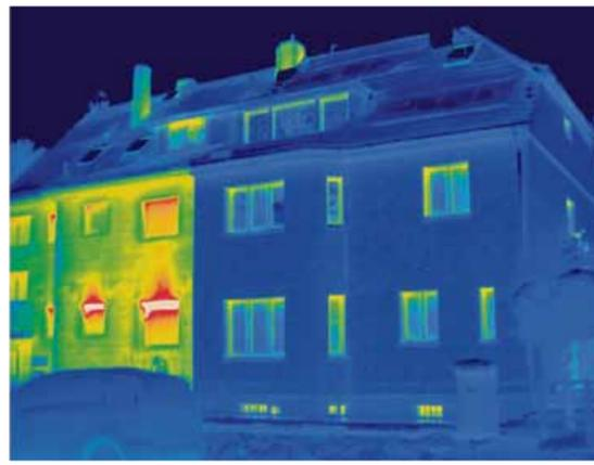
Die Thermografie macht sichtbar, was das Auge nicht sieht: eine gedämmte und eine ungedämmte Außenwand an einem Mehrfamilienhaus.
