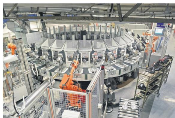
**Roboter kommen bei den verschiedenen Produktionsschritten zum Einsatz, wie hier bei der Besohlung der Sicherheitsschuhe.**
