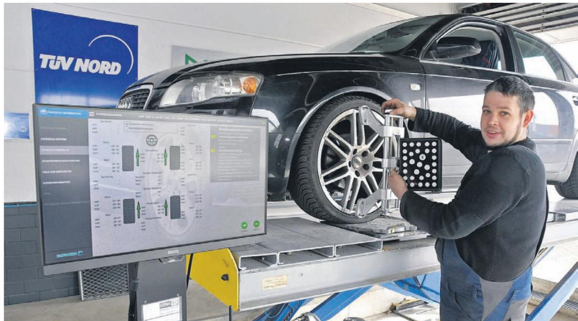
Beim hochmodernen 3D-Achsmessgerät liegen exakte Ergebnisse bereits nach wenigen Minuten vor.
