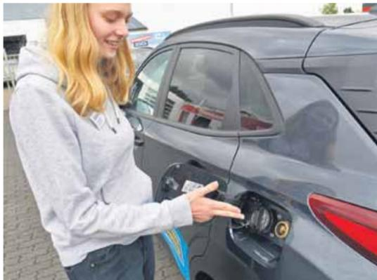
Der Einfüllstutzen für das Autogas wird hinter der Tankklappe angebracht, wie die Auszubildende Nina Sawalt hier zeigt.
