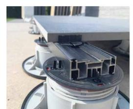
Die eigens für den Terrassenbau konzipierten, robusten Alu-Schienen sind 2 Meter lang und nur 26 mm hoch. Auf ebenem Untergrund können sie direkt mit einem Bodengummi verlegt werden, größere Konstruktionshöhen sowie den Ausgleich von Unebenheiten erzielt man in Kombination mit den perfekt passenden Solid-Terrassenlagern. Die Konstruktion benötigt keinerlei Befestigung zum Untergrund, kann dadurch also auch in Mietobjekten eingesetzt und, falls nötig, rückstandslos zurückgebaut werden. Die
