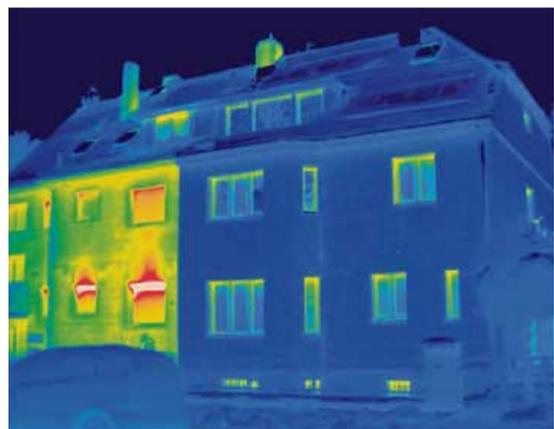
Die Thermografie macht sichtbar, was das Auge nicht sieht: eine gedämmte und eine ungedämmte Außenwand an einem Mehrfamilienhaus. Foto: privat
