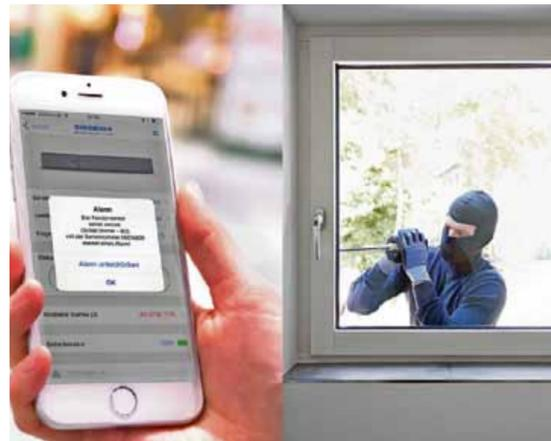
Smarte Sicherheit: Sobald der Fenstersensor einen Manipulationsversuch erkennt, reagiert er mit einem Warnton direkt am Fenster und schickt auf Wunsch eine Push-Nachricht auf ein Smartphone.
